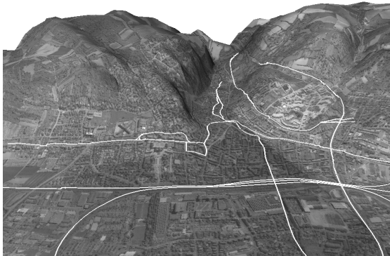
Abbildung 5 Geländeerelief mit überlagertem Luftbild und ATKIS-Daten (Straßen und Eisenbahnen) 2
